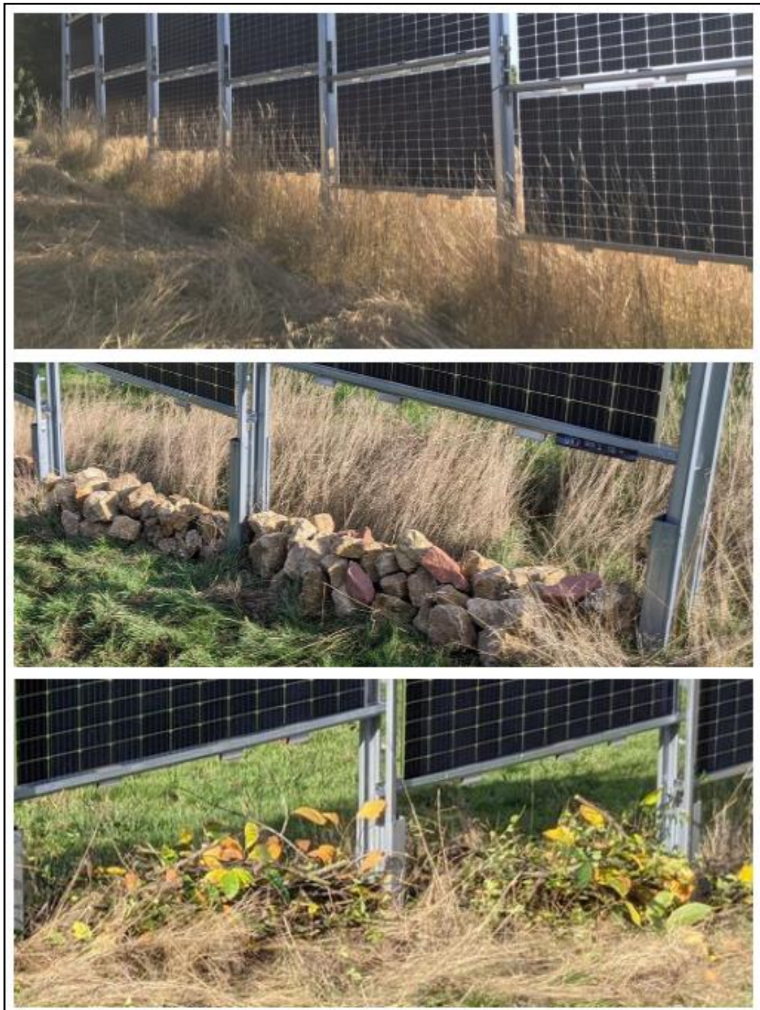
Figur 39. Next2sun har testet innføring av insektfremmende tiltak i sine parker (foto: Next2Sun).
