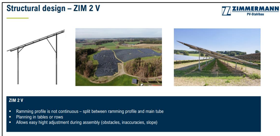
Figur 5. Eksempel på fastmonterte rekker i fast vinkel på et to-pålesystem fra Zimmermann.
